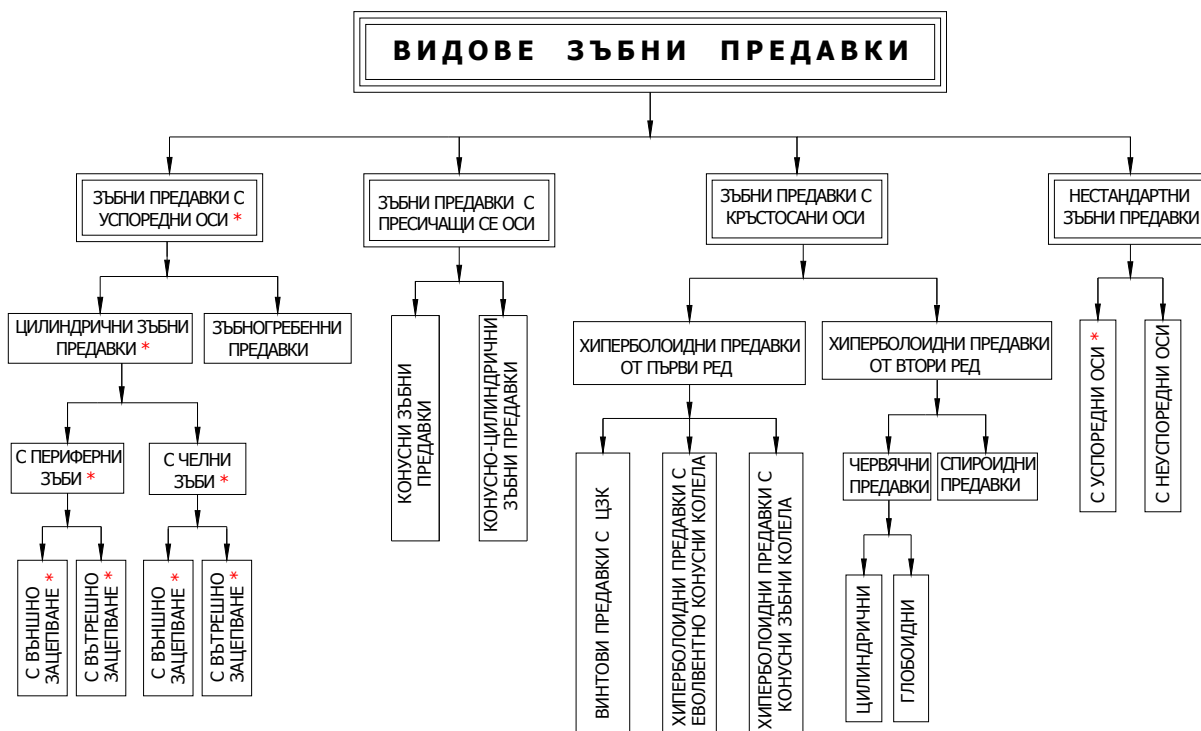
Фиг. 2 Класификация на видовете зъбни предавки, практически намиращи приложение * – предавки, които могат да бъдат изпитвани на реално конструирания стенд
