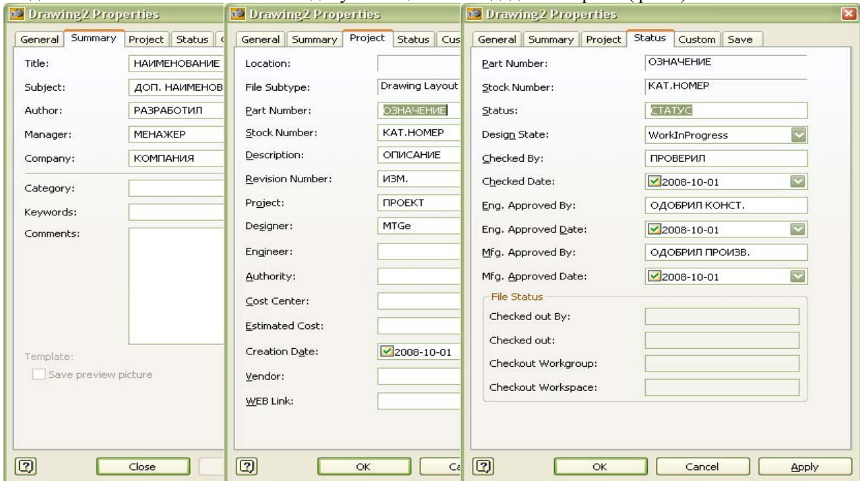
Фиг.4 Основен надпис по БДС ISO – информационни полета в INVENTOR: Дефиниране на текстови полета (Field) в чертежа на основния надпис. Попълване - в прозореца “Drawing Properties” – палети “Summary”, “Project”, “Status”
