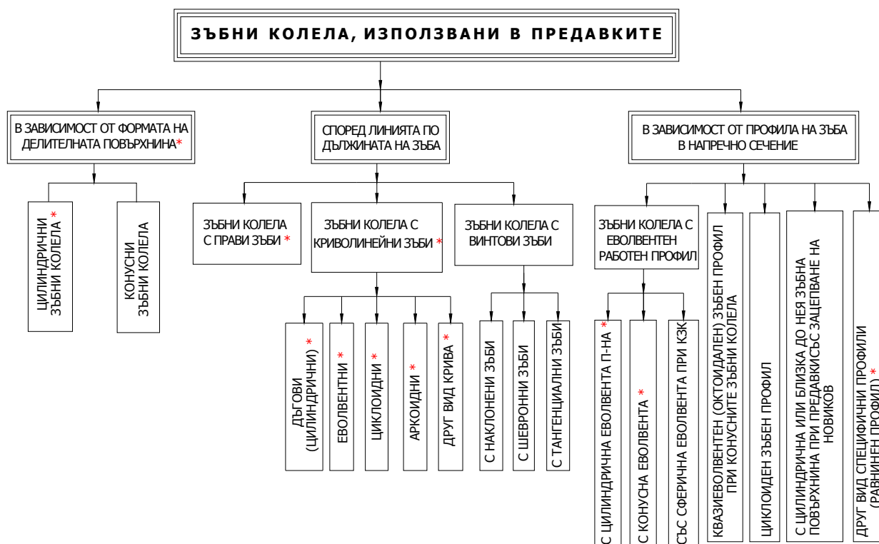
Фиг. 1 Класификация на видове зъбни коелеа, използвани в различните зъбни предавки * – коелеа, които могат да бъдат изпитвани на реално конструирания стенд
