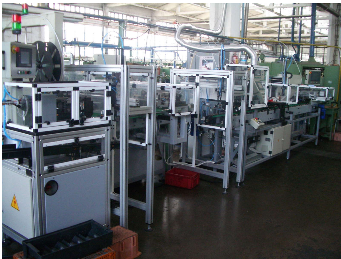
фиг. 2 Автоматична линия за монтаж на котви
