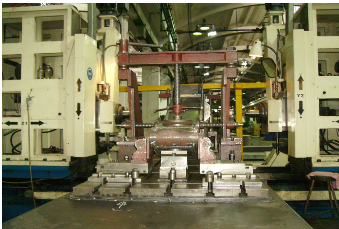
фиг. 3 Прототип на автоматизирана машина за едновременна двустранна съосна обработка на отвори на изделия тип „колони”
