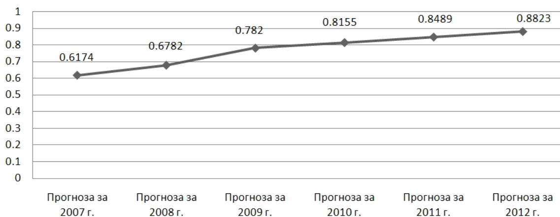
фиг.5.Графика на изменението на прогнозирания масов коефициент на двугредови мостови кранове с товароносимост 5 т и отвор 16,0 – 17,0 м.
