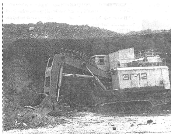
рис.1 Первый отечественный карьерный гидравлический экскаватор ЭГ-12
