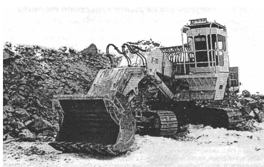
рис.6 Экскаватор ЭГ-110 в забое
