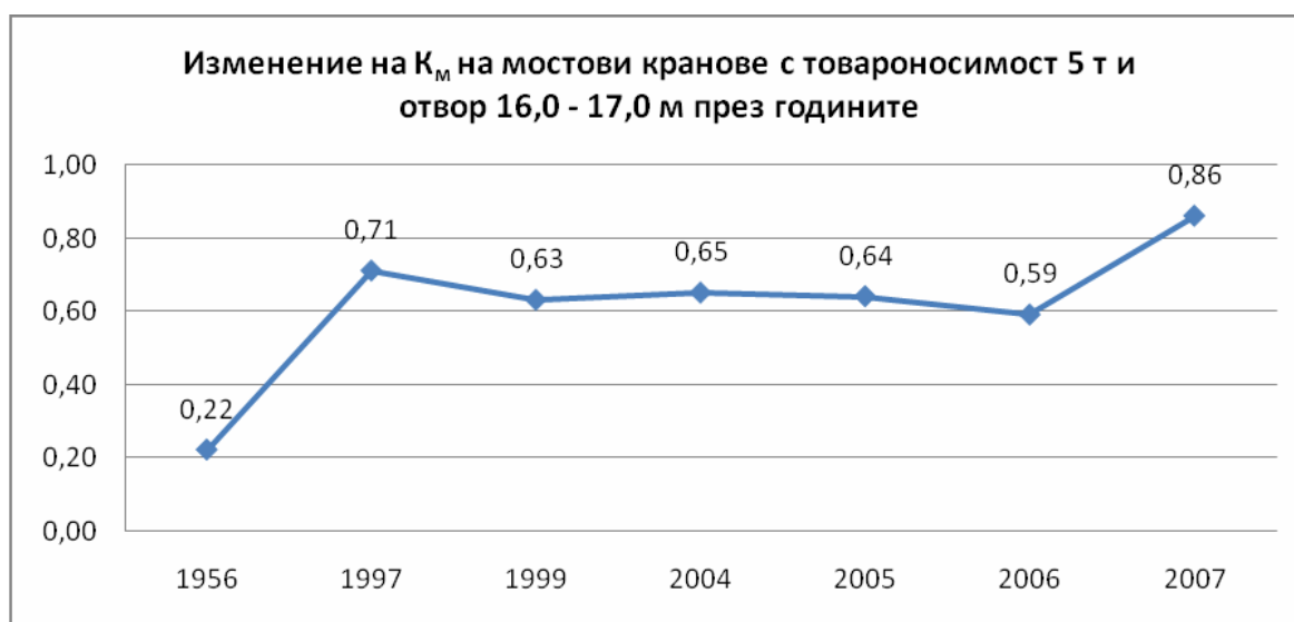
фиг.4. Графика на изменението на масовия коефициент на двугредови мостови кранове с товароносимост 5 т и отвор 16,0 – 17,0 м през годините
