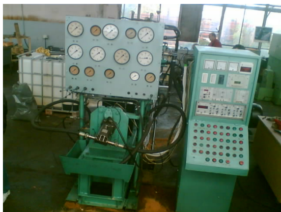
фиг.4 Общ вид на стенда за проверка, регулиране и настройка на регулируеми помпи
