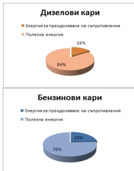
фиг.1 Съотношение между полезна енергия и енергия за преодоляване на съпротивления при мотокари
