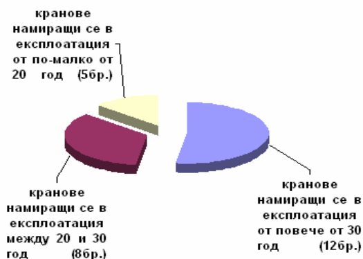
фиг.2 Аварии с товароподемни кранове за периода 2002-2010 поради технически неизправности в зависимост от периода на тяхната експлоатация
