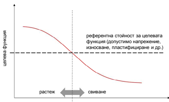
Фиг. 7 Определяне големината и посоката на преместване на повърхностните възли [5]
