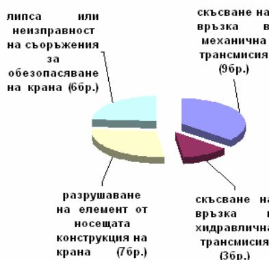
фиг.3 Аварии с кранове за периода 2002-2010 поради техническа неизправност
