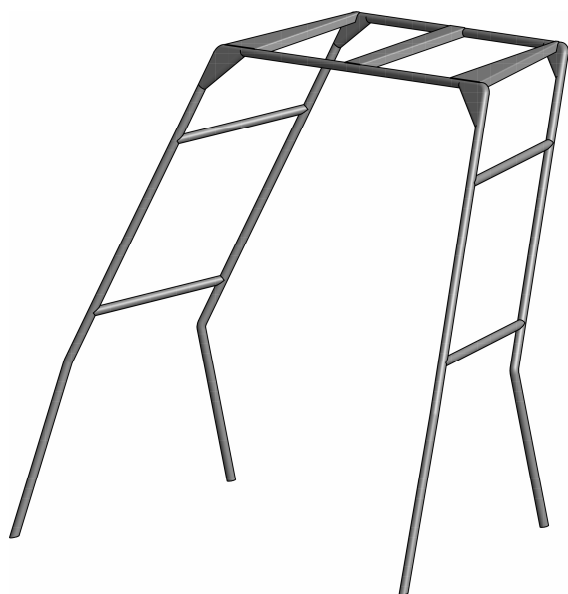
фиг.2 Геометричен модел на Рамка, моделирана като един детайл
