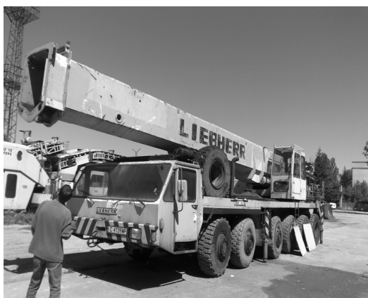
Фиг.2. Автомобилен кран Liebherr повреден по време на работа, поради изгубване на устойчивост
