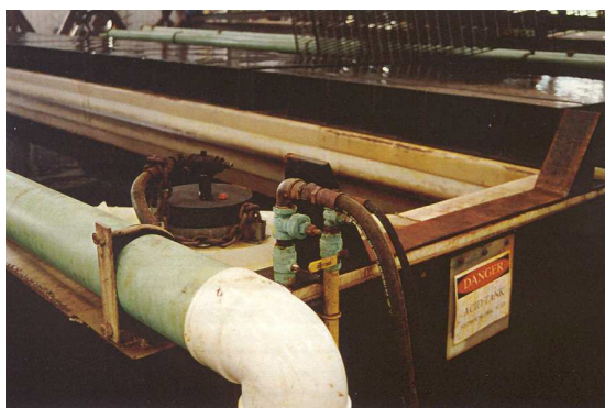
фиг.3 Системи за подаване на гориво (природен газ) и съгъстен въздух в технологичния резервоар.
