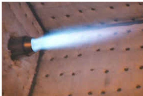
фиг. 4. Газова горелка за нагряване на киселинните разтвори в процес на изпитване (без защитен въздушен мехур).
