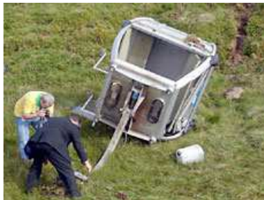
фиг.4б) Кабина паднала от транспортното въже
