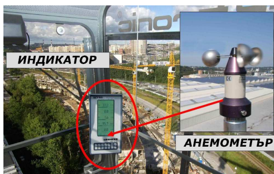
Фиг.1. Измерване и отчитане на скоростта на вятъра с помощта на анемометър и индикатор в кабината на краниста
