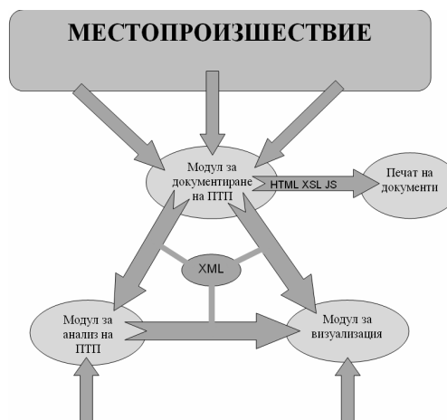
фиг.10 Общ модел на системата и взаимовръзките между съставните и модули
