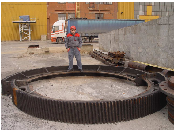
фиг.1 Съставно зъбно колело от топлоелектрическа централа
