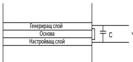
фиг.7 Настройваща се система използваща двата пиезоелектрични слоя за настройка
