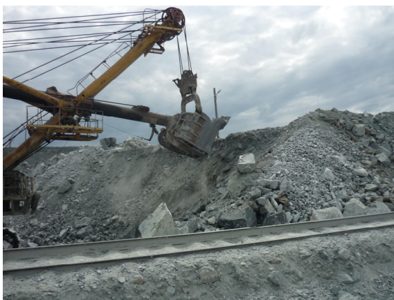
рис.10 Забой и рабочее оборудование экскаватора
