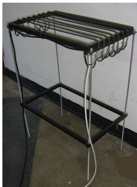
фиг. 4 Система за натоварване с електрически нагреватели
