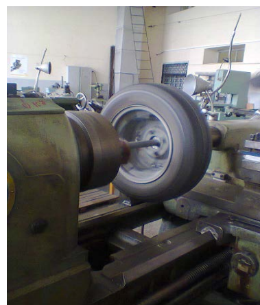
фиг.3. Снимка на опитната установка – струг С13, дорник и джанта с гума, монтирана в нея
