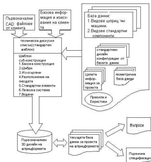
фиг.2 Методика на модерния конструктивен подход при създаване на шприцформи
