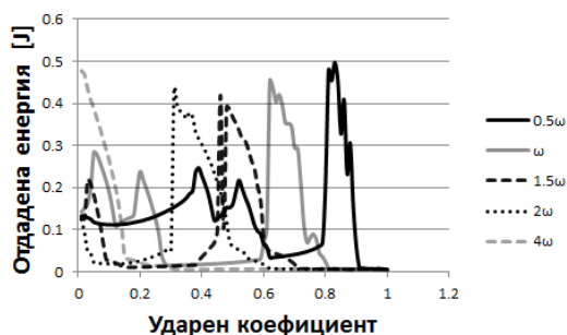
фиг. 11 Симулирана отдадена енергия от конзолните пиезоелектрични пластини.
