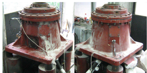
фиг.3а) Разположение на акселерометрите върху КИД-300 при измерване на принудени трептения
