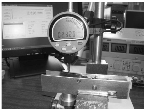
фиг. 4 Стенд за изследване на радиаторни клапани управлявани чрез СПФ разработен в катедра ТММ, ТУ-София [1].
