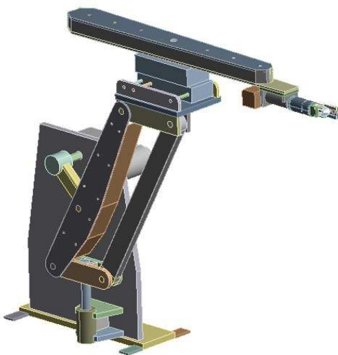
фиг.14 Опростен модел на манипулатора с лостов механизъм
