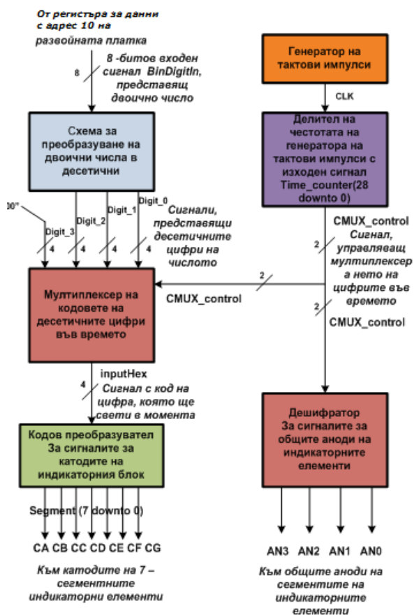
Фиг.3 Блокова схема на проектираното устройство
