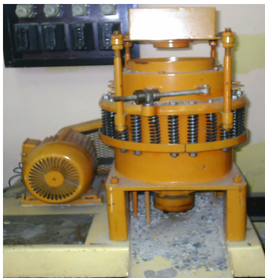
фиг.1 Лабораторна конусна трошачка с конзолно лагеруван подвижен конус
