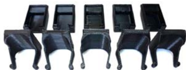
фиг.14 Принтирани с помощта на 3д принтер клипси за пръстите, с различни размери настроени под всеки пръст и с пасивна горна капачка.[1]
