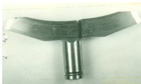
фиг.1 Разрушеният детайл „плъзгач” от стомана ШХ15СГ
