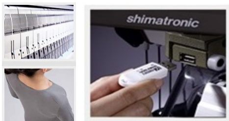
фиг.9 Сегментен изтеглителен механизъм и зареждане на програмите на машината чрез флаш памет [2]
