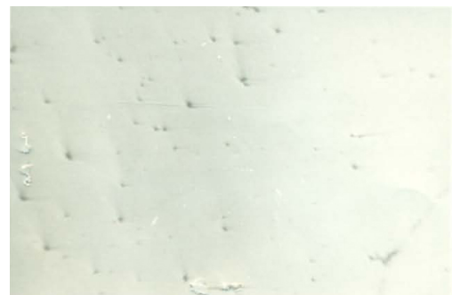
фиг.3 Неметални включвания: окиси и сулфиди в микроструктурата на детайла от стомана ШХ15СГ.
