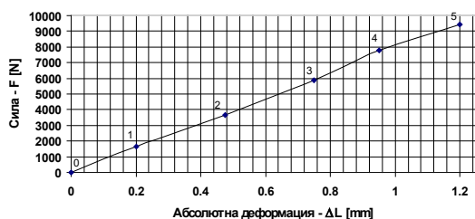
фиг.3 Зависимост сила - абсолютна деформация на пробното тяло, изработено от нисковъглеродна стомана с концентратор на напреженията.
