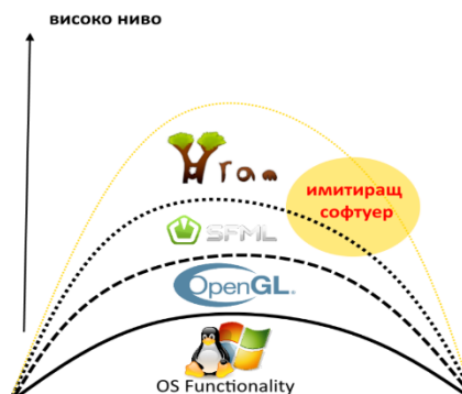
фиг. 2 Схема на покритието на възпроизвеждащ софтуер по отношение на операционната система
