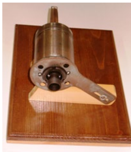
Фиг.7 Блокиращ контур и практическа реализация чрез оптимизация на резбонарезна глава „Тарматик” с профилни ъгли на инструмента \alpha=20^\circ и \alpha^*=30^\circ
