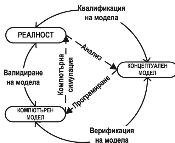
фиг. 4 Фази на процеса на моделиране и симулация [11], (Schlesinger, 1979 by Simulation Councils, Inc.)
